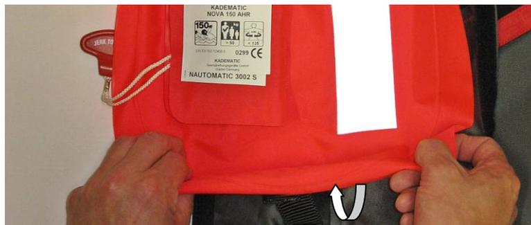
Die linke Kante des Auftriebskörpers unter die Automatik stecken, damit die Handauslösung später nach außen hängen kann.
